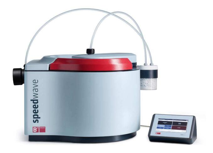
Le speedwave XPERT établit de nouveaux standards en terme de préparation d'échantillon. Grâce à une technologie innovante et brevetée de capteurs et la haute qualité de ses composants, vous bénéficierez de digestions fiables et reproductibles. La robustesse des matériaux et la durée de vie exceptionnelle des réacteurs réduisent considérablement le coût de vos minéralisations.
